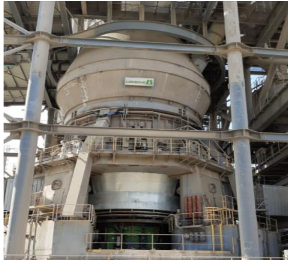
Figura 22: Molino vertical de cemento- Principio de funcionamiento
