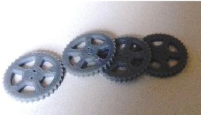
Ilustración nº 54: Botones diseño personal en mdf, corte laser y en prototipado 3D.
