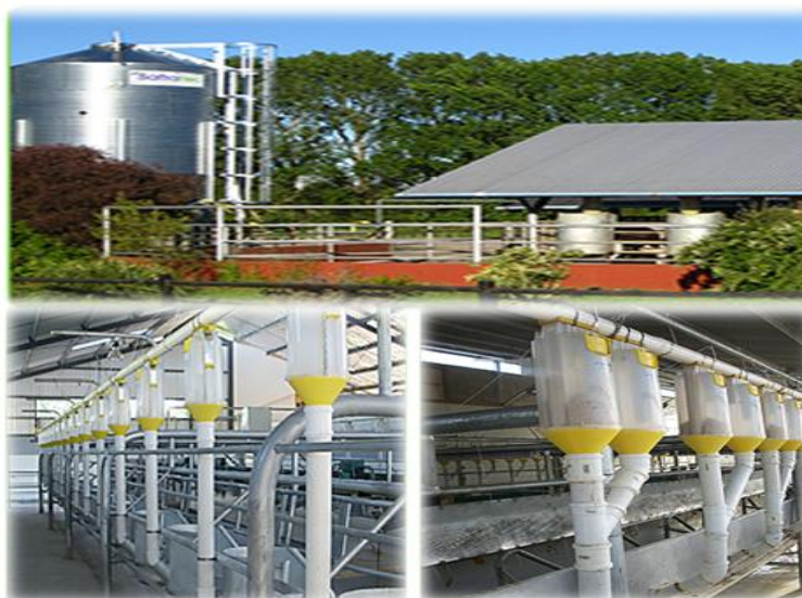
Imagen 6: Sistema de alimentación automatizado dentro de la sala de ordeño.
