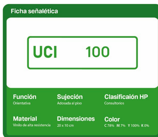
Figura 86 Ficha señalética, señal adosada a piso P1
