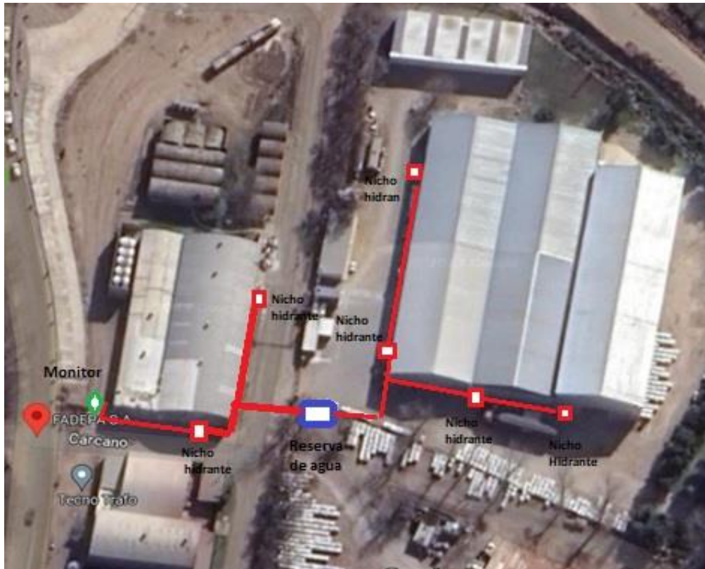
Imagen 5. Tomada de google maps, modificada, muestra reserva de agua, red, nichos hidrantes y monitor.
