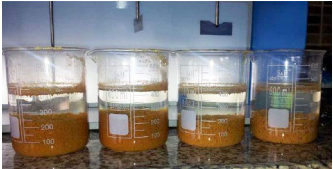
Ensayo de precipitación en equipo Jar test. (Damla, 2016)
