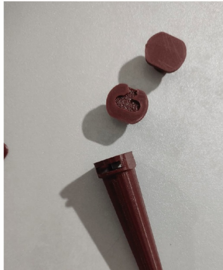
PRUEBA DE PROTOTIPADO EN IMPRESION 3D (EN MATERIALIDAD PLA MARRON) DEL ENVASE 6: CANNAPRO
