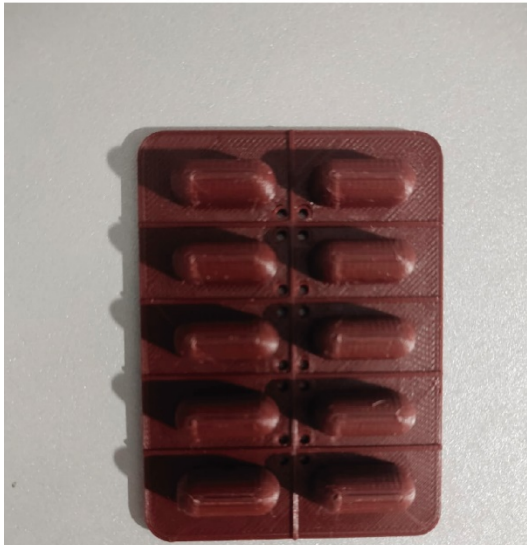
PRUEBA DE MOLDE PARA TERMOFORMADO DE CAPA SUPERIOR DE BLISTER
