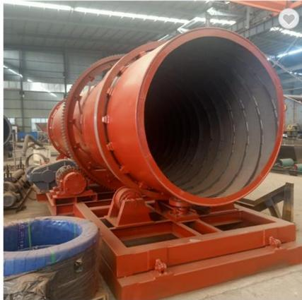
Secador rotativo de piedra montado para planta de lavado de piedras
