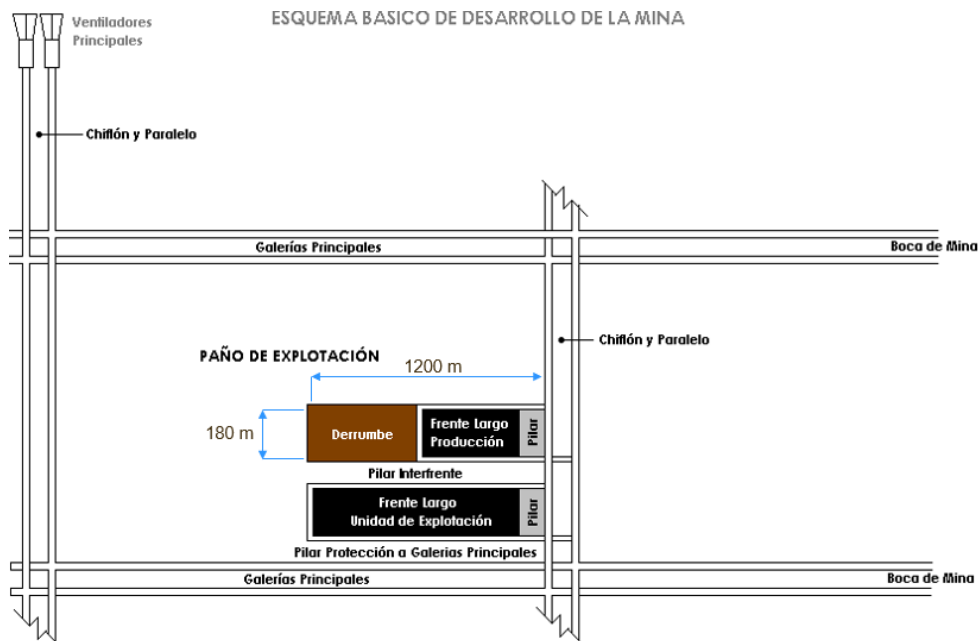
Figura 17. Esquema básico de desarrollo de frentes largos en YCRT.
