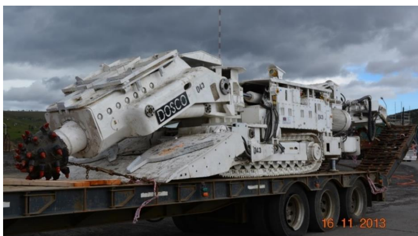
Figura 20. Tunelera DOSCO de un cabezal escareador. Origen Polonia.
