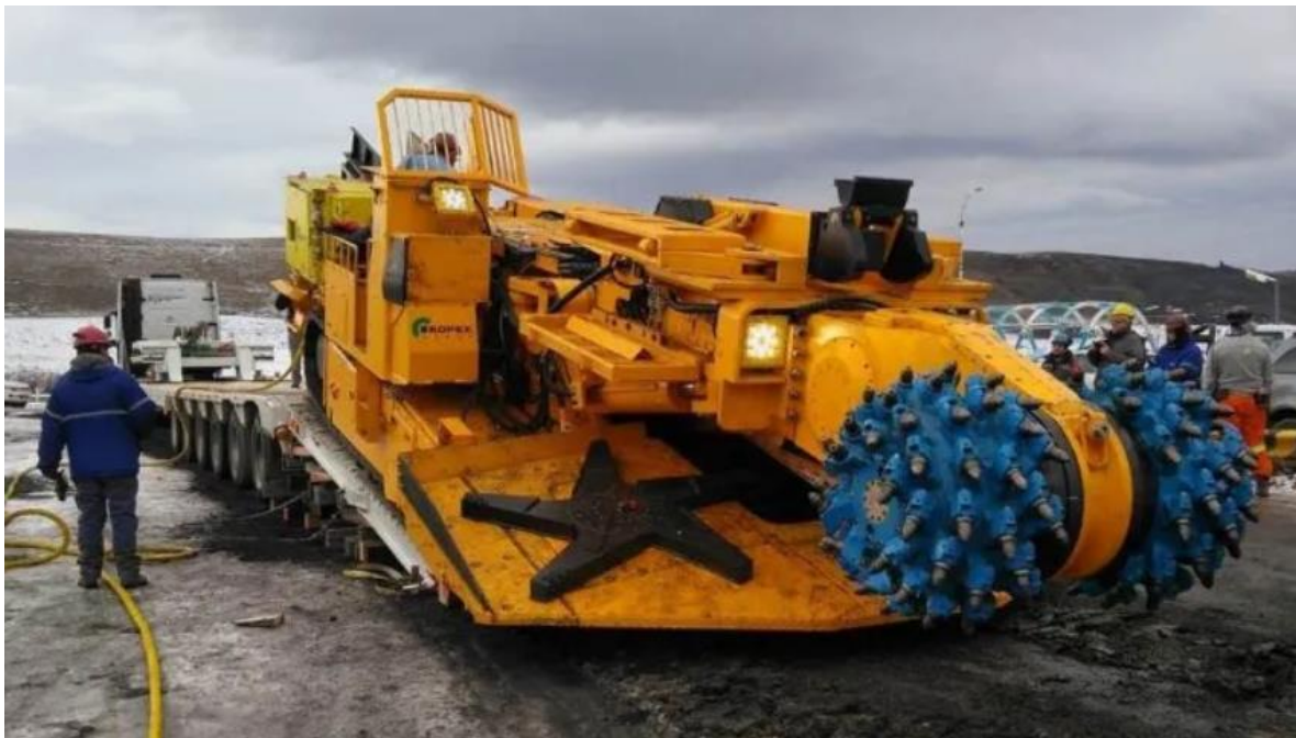
Figura 25. Tunelera en estéril FAMUR. KTV - 200.
