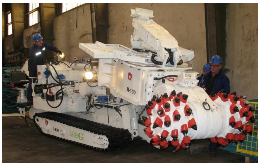
Figura 21. Tunelera Remag R -130 de doble cabezal escareador. Origen Polonia.
