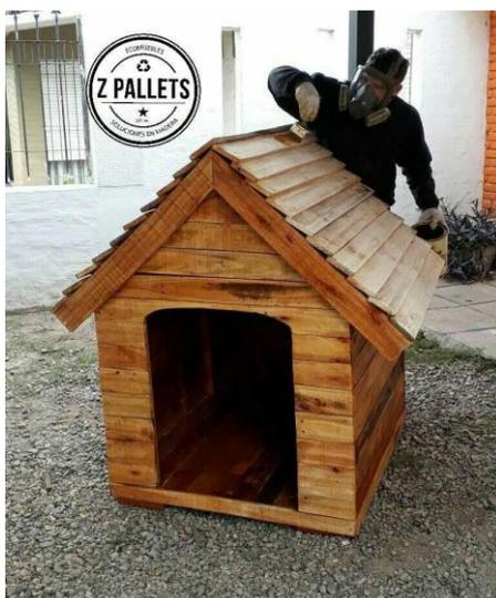
*Nota:* En la foto se observa que se realiza el pintado de muebles al aire libre y el personal está utilizando una máscara completa con filtros y un par de guantes.
