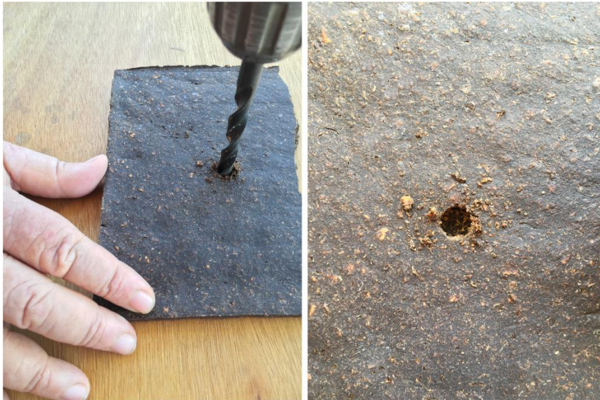
Imagen 9: Proceso de perforado Alvinic ORUJ. Fuente: elaboración propia, 2022
