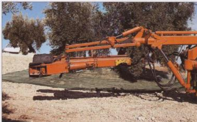
Detalle del cabezal de un vibrador multidireccional de troncos empleado en la recolección mecánica de la aceituna.
