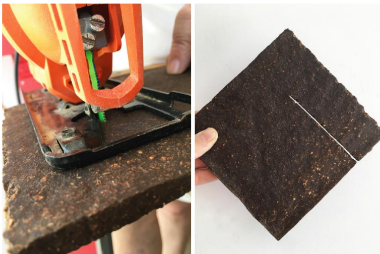
Imagen 8: Proceso de calado Alvinic ORUJ. Fuente: elaboración propia, 2022
