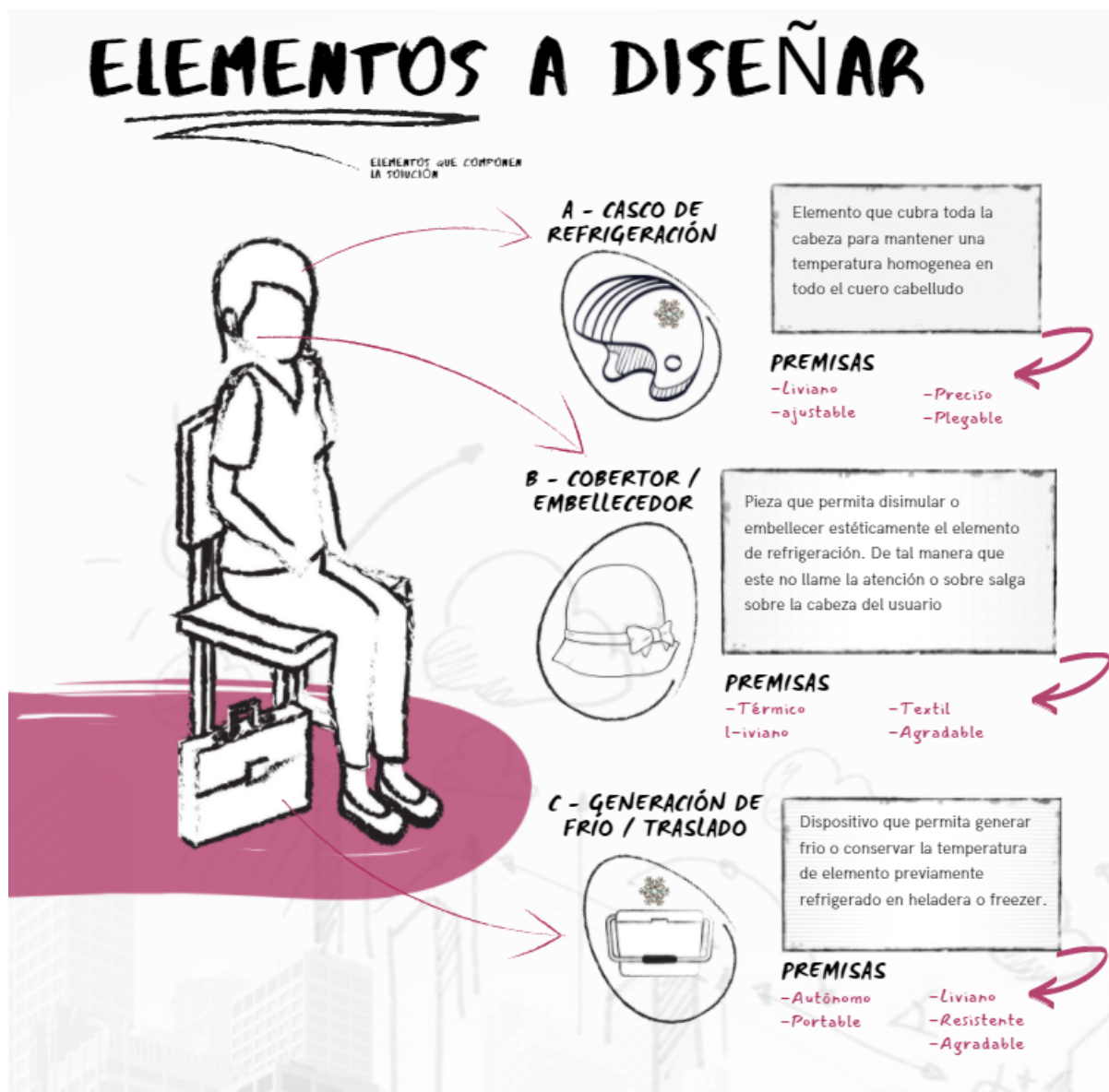
Figura 15: "Elementos a Diseñar". Fuente: Elaboración Propia (2021)
