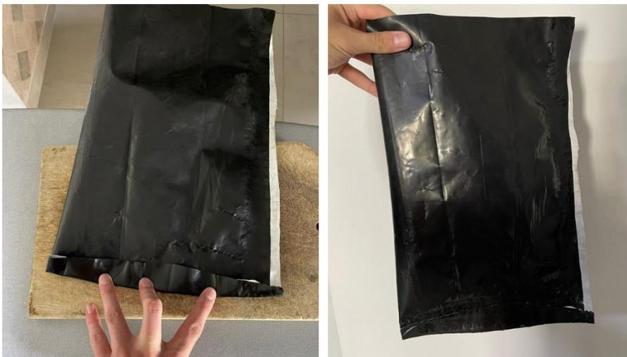
**Imagen 35. Termofusión casera.** Fuente: Elaboración propia
