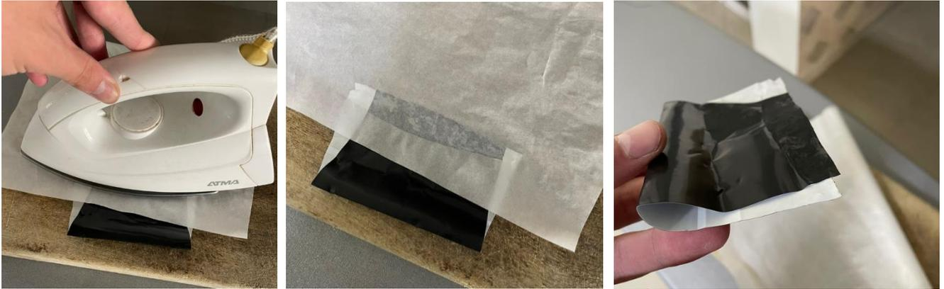
**Imagen 34. Termofusión casera.** Fuente: Elaboración propia
