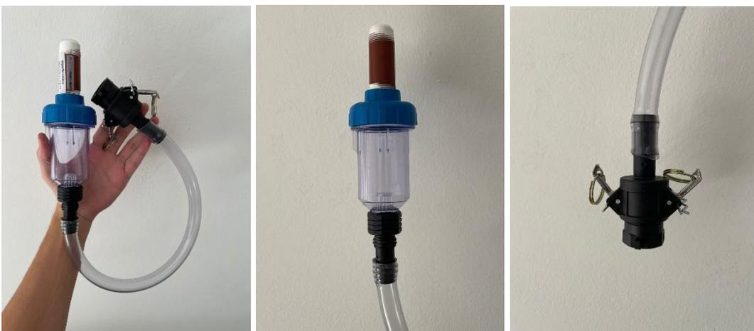
**Imagen 37. Prototipado de acoples.** Fuente: Elaboración propia
