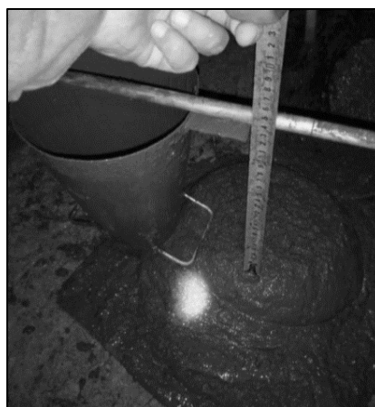
Figura 8: Ensayo realizado luego de agregar reductor de agua
