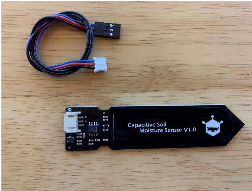
Ilustración 1: Sensor de capacitor de humedad en tierra DFRobot.
