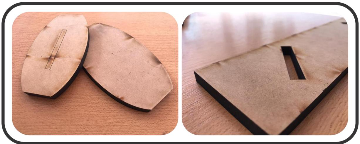
FIGURA 3. Aspecto del MDF después del corte por láser. Elaboración Propia
