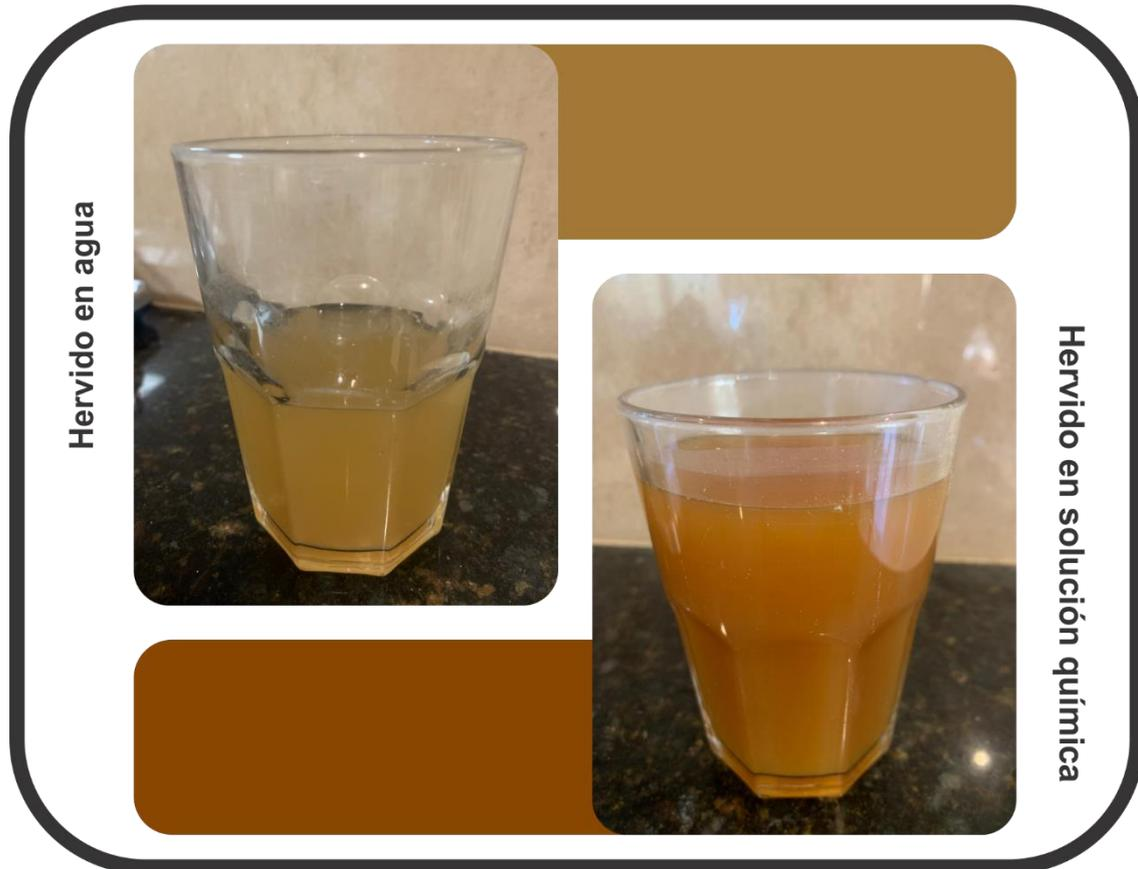
FIGURA 49. Color del Agua con Resina. Elaboración propia.
