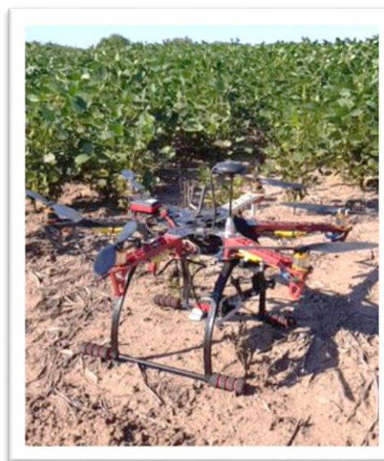
Figura 10 - Vehículo Aéreo No Tripulado Multirrotor de Desarrollo Propio.
