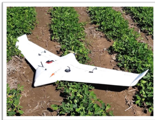
Figura 9- Vehículo Aéreo No Tripulado de Ala Fija de Desarrollo Propio.
