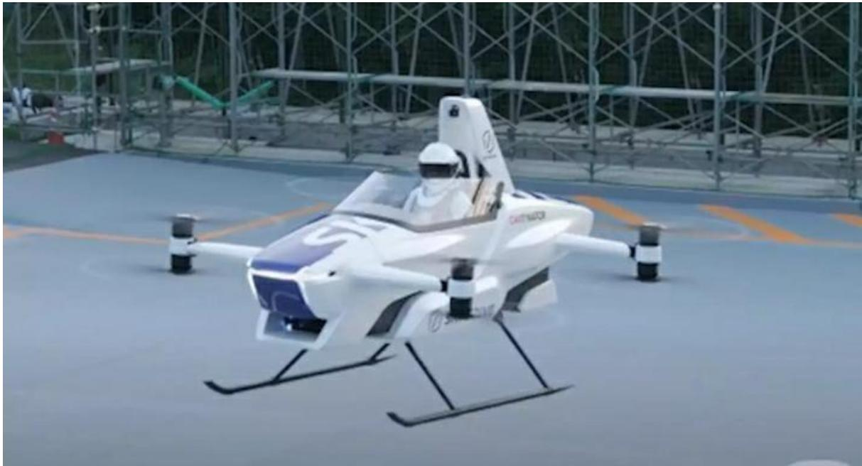
**La startup japonesa SkyDrive acaba de demostrar un automóvil volador a batería con la esperanza de comenzar el servicio para el público en 2023.** El vehículo que demostró tal destreza en una parte montañosa de la ciudad de Toyota tenía solo un asiento y fue pilotado por un ingeniero de la compañía que mantuvo su velocidad por debajo de las 3 millas por hora. La demostración se llevó a cabo en una jaula porque SkyDrive aún no tiene permiso para realizar pruebas al aire libre.
