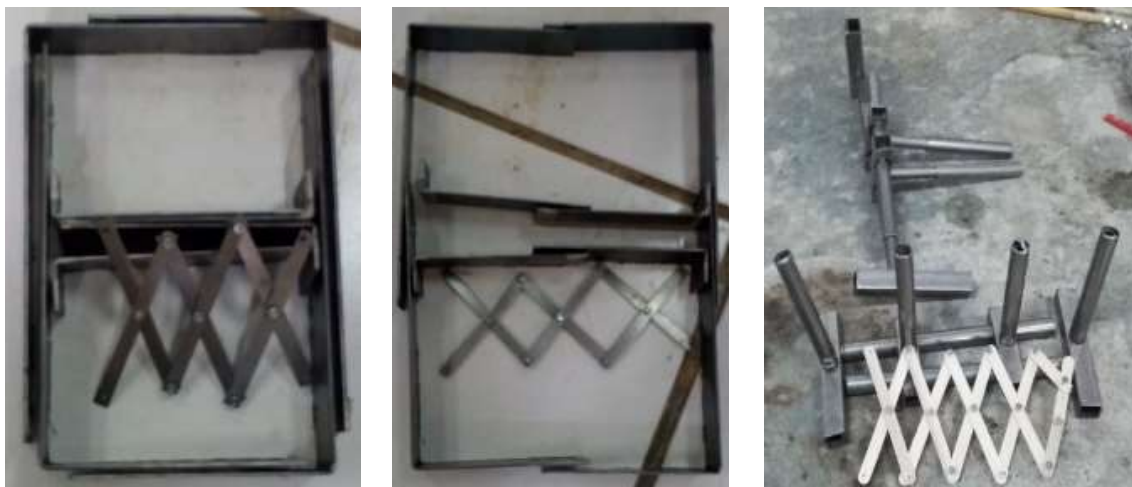
Figura 117. Pruebas mecanismos de accionamiento por tijera (22 de enero de 2019). Elaboración propia.
