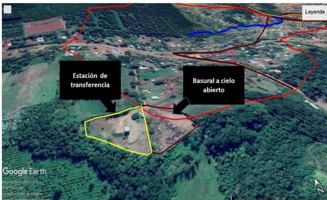
En la imagen se ve la ubicación de la estación de transferencia de residuos y en forma contigua el basural a cielo abierto, en la parte alta de la microcuenca, sobre el parteaguas. Fuente Google Earth. Con aportes de elaboración propia.
