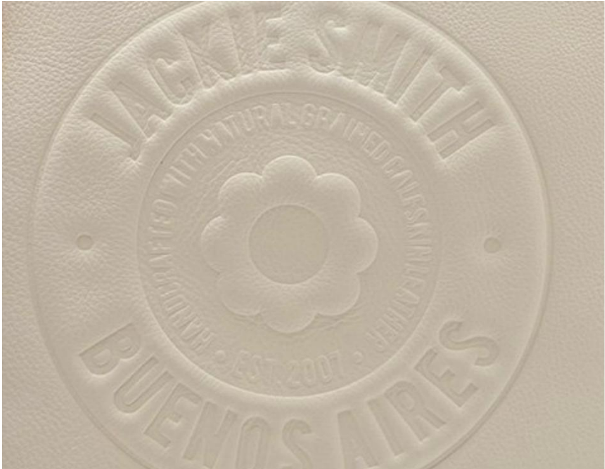
Ilustración 76 Gofrado de manera industrial, utilizando matriz. FUENTE: Jackie Smith, disponible en https://jackiesmith.com.ar/products/gf00636gnd58099 extraído el 28-01-19
