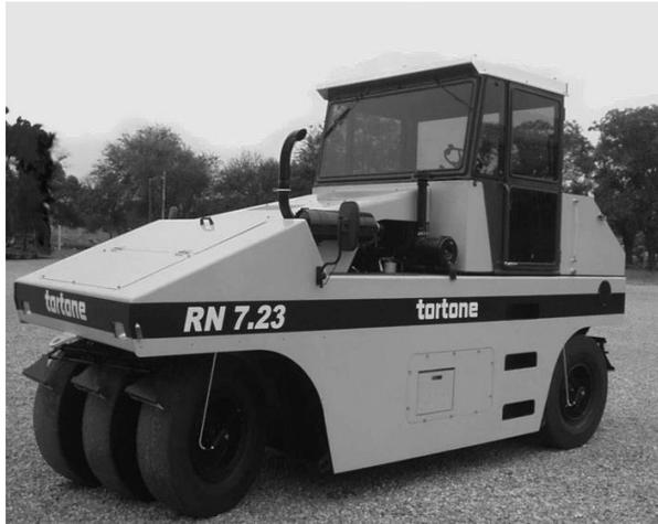
*Figura 8: Compactadora sobre neumáticos TORTONE*
