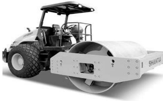
*Figura 7: Aplanadora Vibrante Autopropulsada SAKAI*
