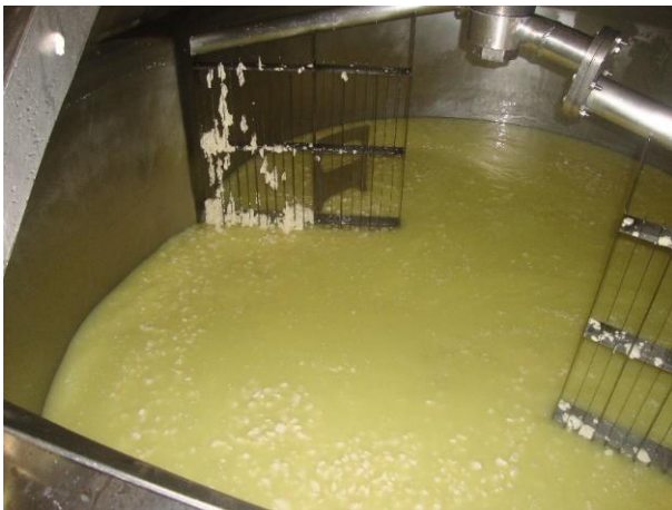
Figura 10. Corte y agitado de la cuajada.
