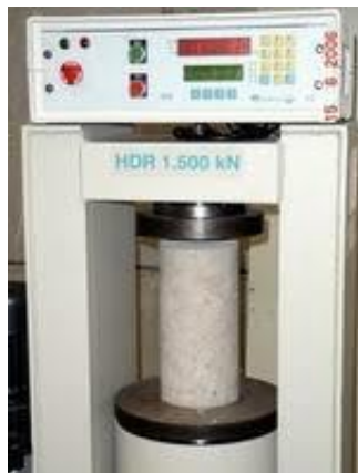
Ilustración 14 Prensa hidráulica para probetas de hormigón
