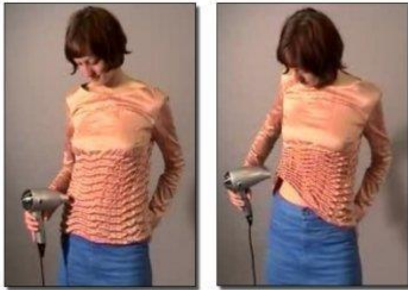
Ilustración 8. Blusa con tecnología de memoria de forma, en su estado natural y bajo el efecto del calor.
