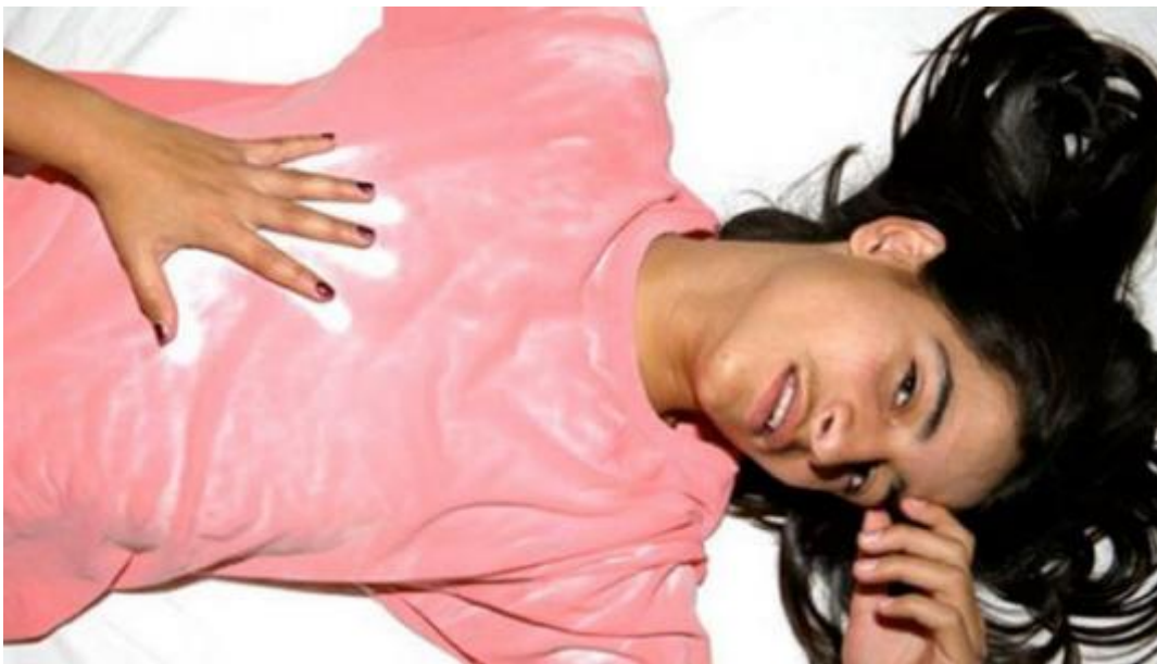
Imagen 14. Textil termocrómico. Remera que cambia de color con la temperatura.
