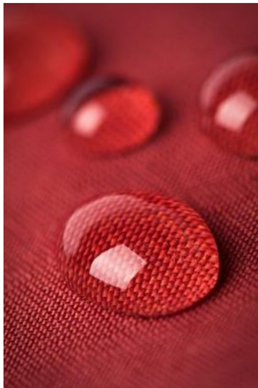
Imagen 20. Nanotecnología. Textil impermeable, se mantiene seco.
