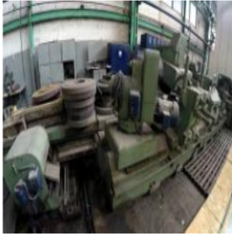
Imagen N° 3 Rectificadora Universal Gilly 5 Mts
