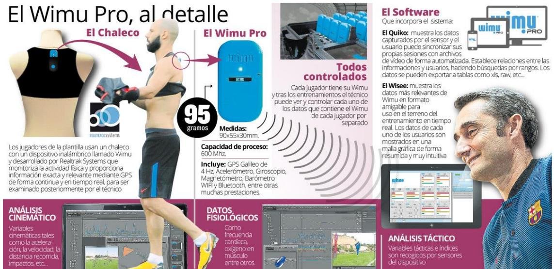
Figura 6. Detalle del funcionamiento del sistema Wimbu Pro (Pérez, 2017).
