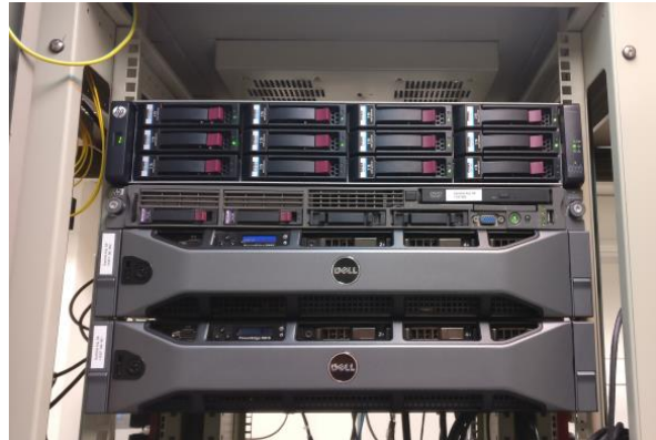
Imagen 4: Vista de dos server DELL, uno HP y un Storage HP en su Rack
