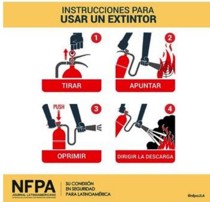
Figura 44. Instrucciones básicas para utilizar un extintor. Fuente: NFPA Journal Latinoamericano.
