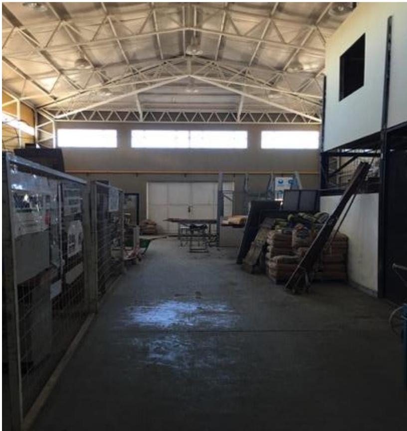
Figura 28. Ausencia de señalización horizontal y vertical de vías de evacuación.
