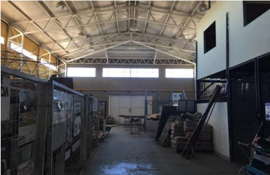
Figura 27. Ausencia de señalización horizontal y vertical de vías de evacuación.
