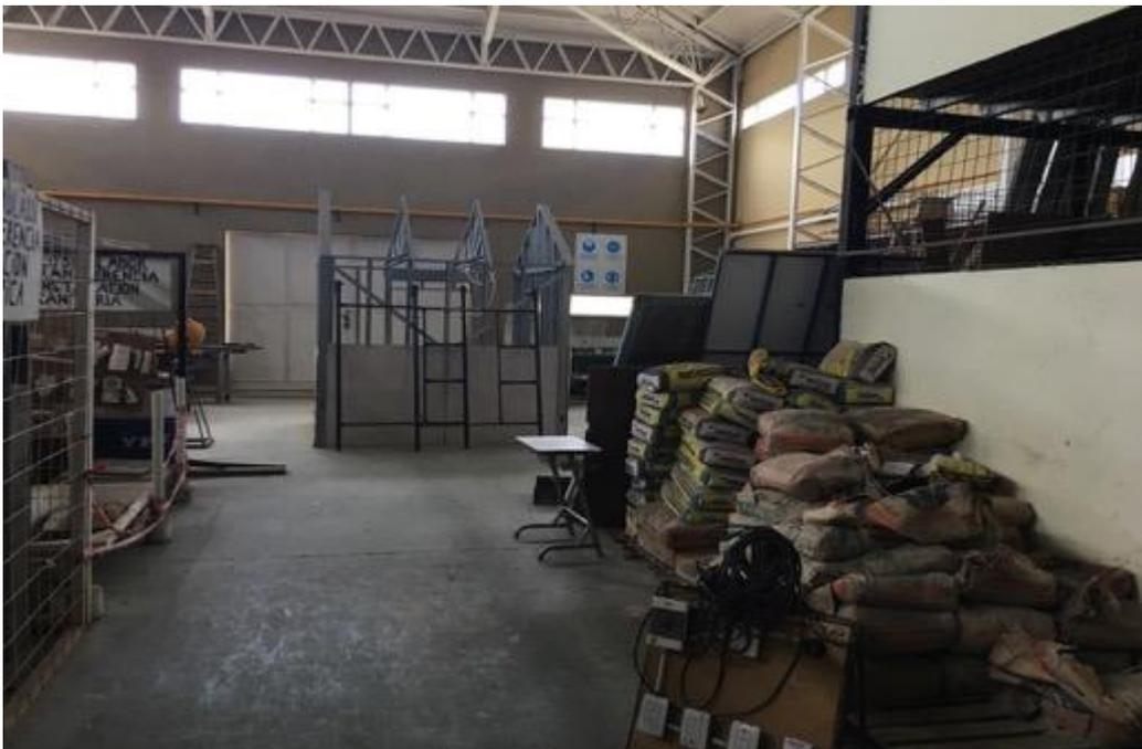
Figura 20. Materiales de trabajo almacenados incorrectamente.
