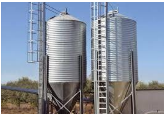
Figura 12. Silo para almacenaje de expeller o acopio de soja
