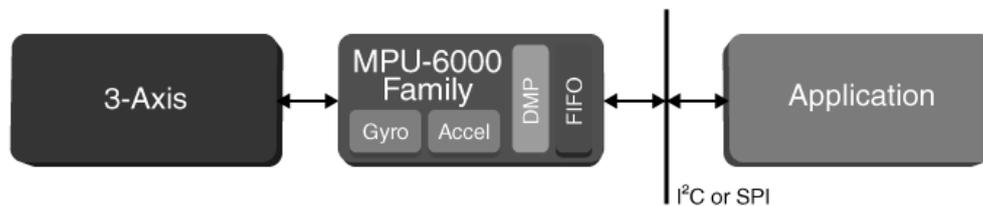
Figura 16 Esquema circuito integrado de un microacelerómetro (InvenSense Inc., 2016)
