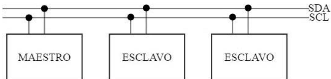
Figura 10 Diagrama de conexión  $I^2C$  (Artero, 2013)
