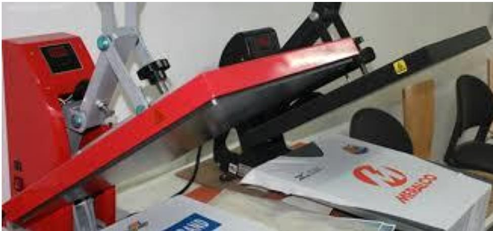
*Ilustración 17- Estampación por medio de termotransferencia.*
