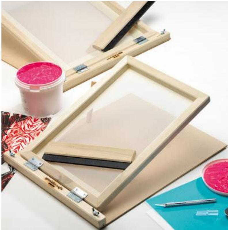
*Ilustración 10 - Elementos para realizar serigrafía*
