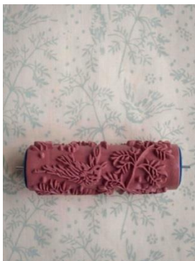
Imagen 29: Ejemplo de un rodillo de grabado.
