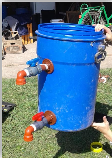
Figura 13. Vista del colector de efluentes terminado.
