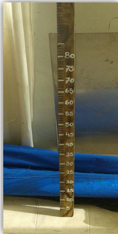
Figura 11. Regla utilizada para medir el nivel de agua de la fosa.
