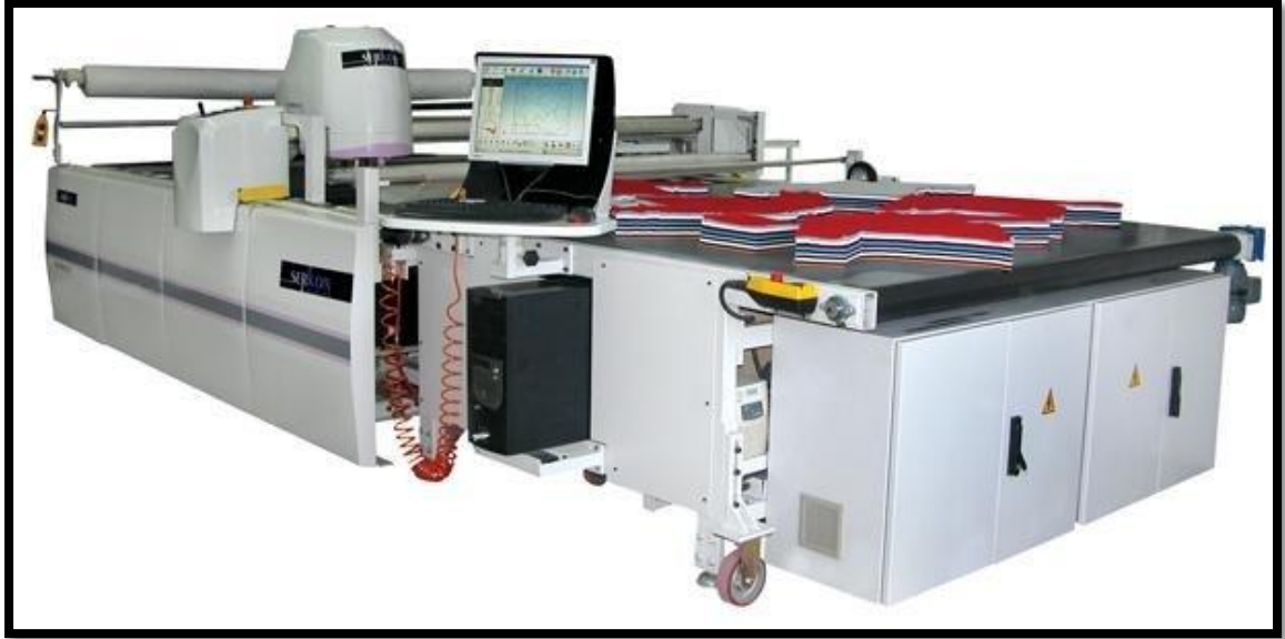
Figura 97: Máquina de tizada y corte automático de telas. Funciona con soporte digital.
