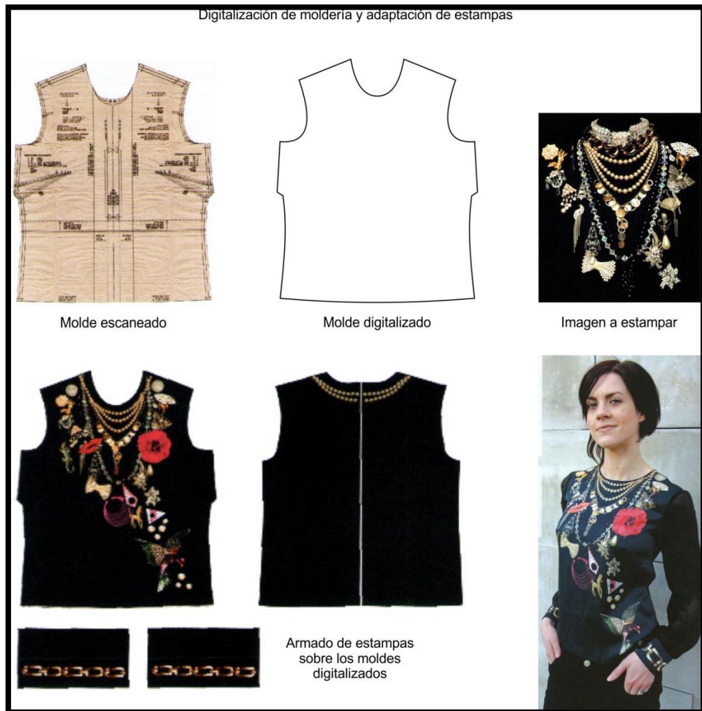
Figura 101: Pasos de digitalización de moldería y estampado, y su combinación.
