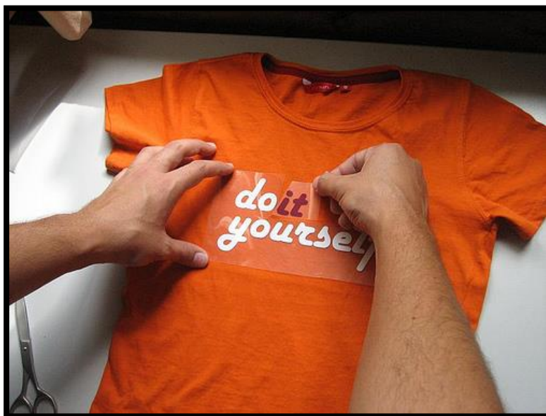
Figura 57: Estampado con vinilo thermotransferible
