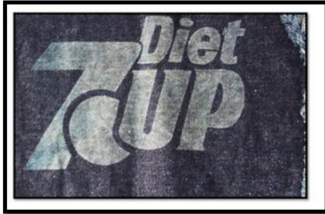
Figura 52: Estampado por corrosión
