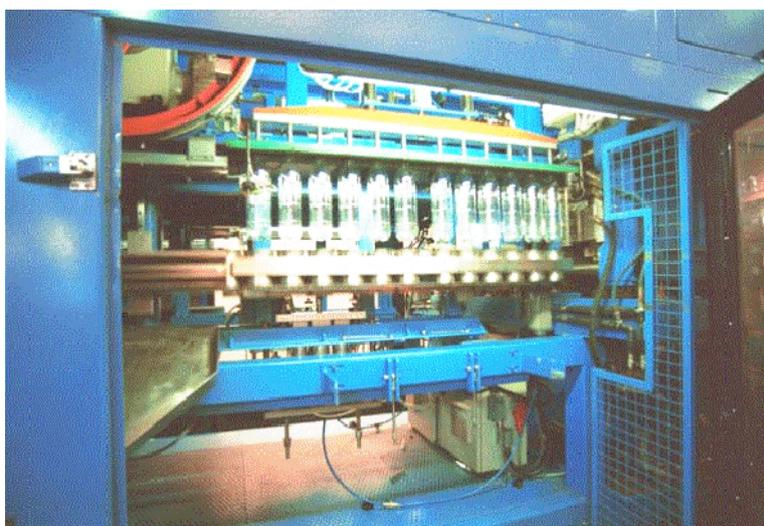
Figura N° 1: Máquina Sopladora.
