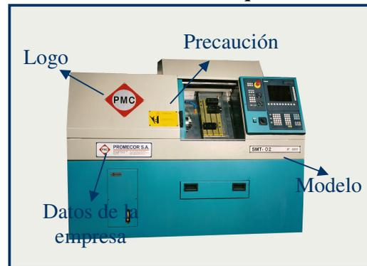
Los Tornos están equipados con un control numérico que puede ser Siemens o Fanuc, aire acondicionado, extractor de virutas, entre otros.
