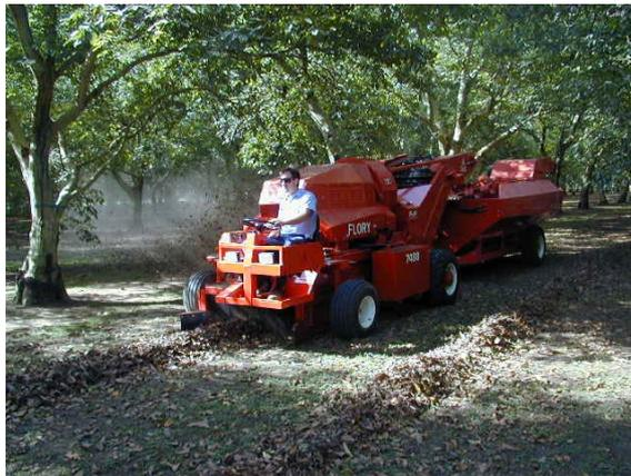
Figura N° 10: Cosechadora autopropulsada con cono recolector
