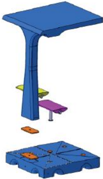
estructura de caño soldada y abulonada a los insertos de el promoldeado de el piso.
