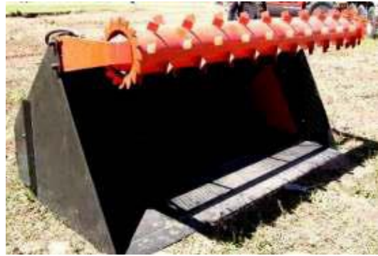
Freza de autocarga de un mixer horizontal moderno Freza de autocarga incorporada a una pala frontal.
