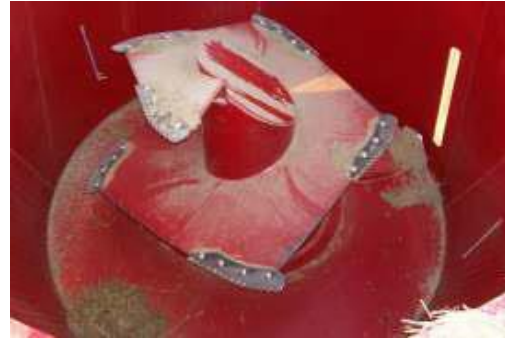
Sinfín de mezclado y corte de fibra de mixers verticales.
