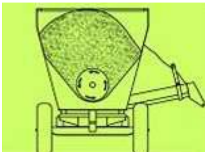
Esquema de un acoplado mixer de un solo sinfín horizontal, trozador y mezclador.
