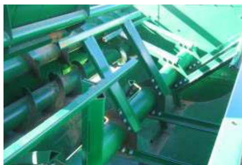
Interior de mixer de mezcla vertical con paletas divididas
