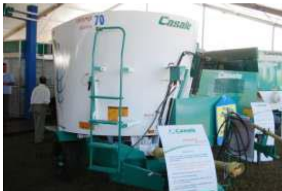
Mixer con sistema de transmisión de datos en tiempo real, sobre carga y descarga de alimentos.
