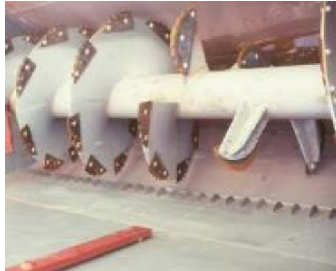
Sistema de un sinfín con cuchillas y barra batidora central.
