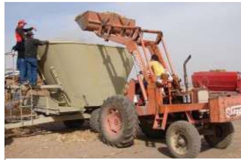
Cargando el mixer vertical con silo de maíz picado fino mediante una pala cargadora. (Fuente: INTA PRECOP, 2009).
