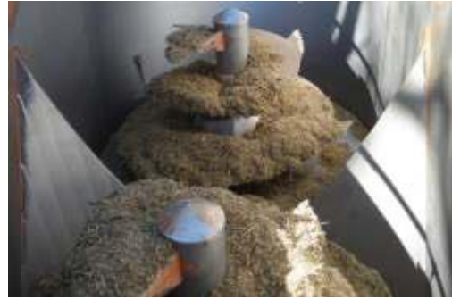
Doble sinfín de mezclado en acoplado de mayor capacidad de carga y trabajo (Fuente: INTA PRECOP, 2009).
