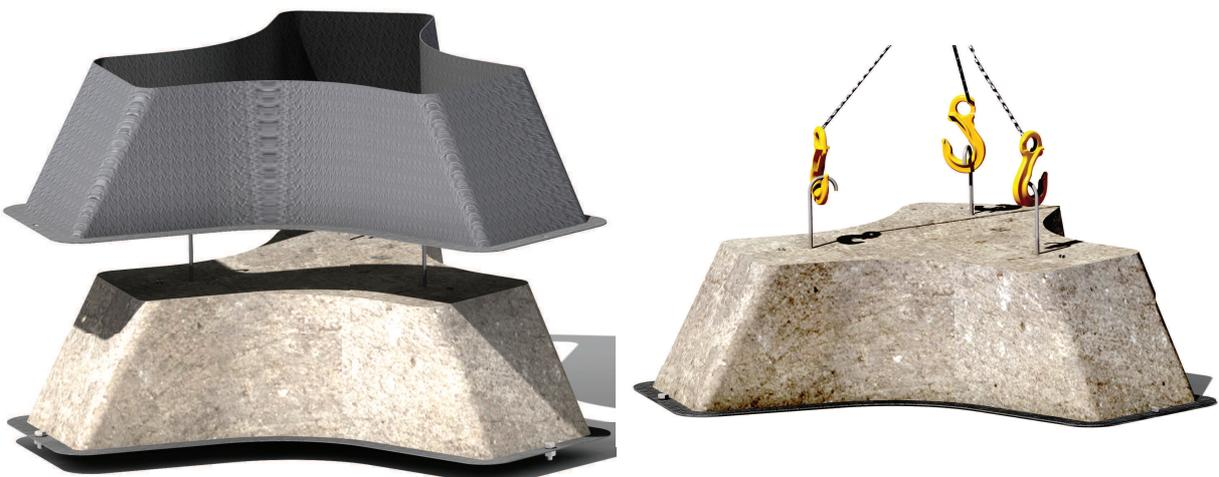
Una vez extraída la pieza del molde, se sumerge en una solución ácida para eliminar la superficie más externa del cemento y dejar a la vista el aspecto y el color natural de los áridos que la integran, resultando una superficie lisa de textura arenosa. Este proceso se utiliza para cualquier tipo de elemento con acabado decapado en diferentes grados de rugosidad de su textura.
