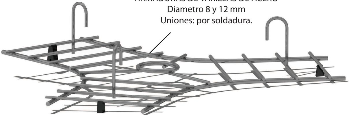
**HORMIGÓN ARMADO** :Es el resultado de combinar debidamente hormigón fresco y armaduras pasivas de acero para producir un elemento que resiste acciones que provocan tensiones de compresión y de tracción.
