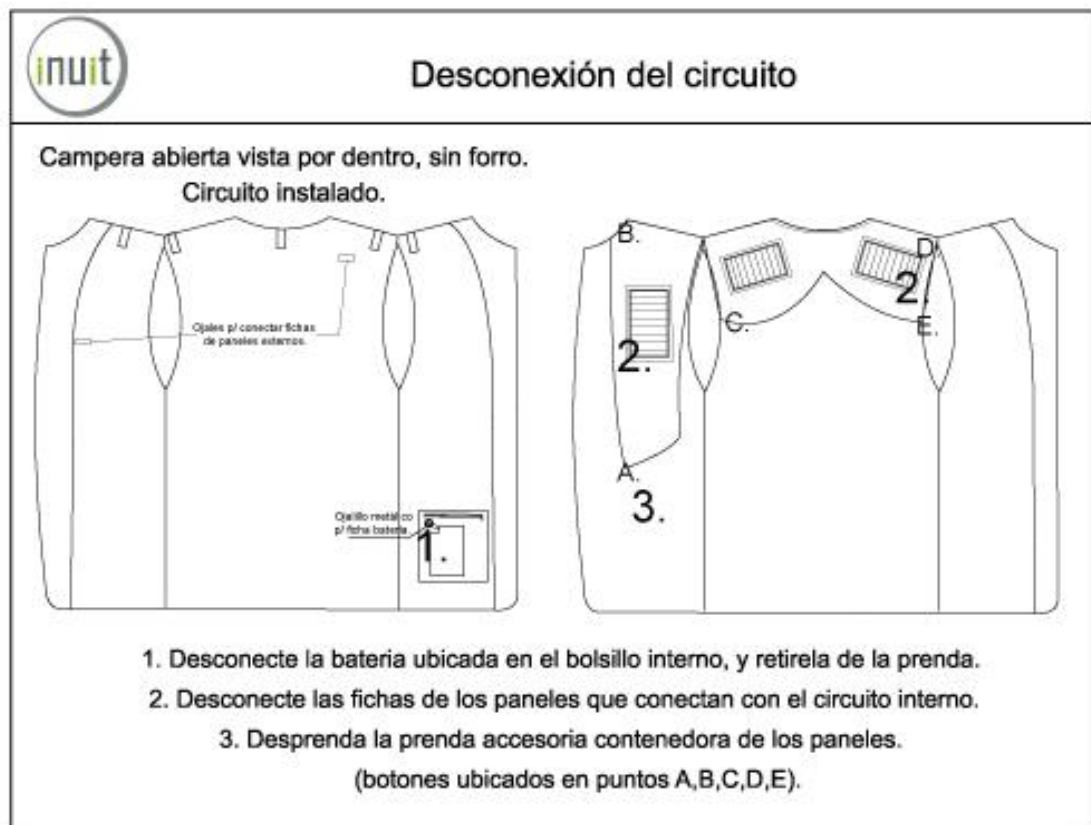
Imagen 46. Esquema e instrucciones de desconexión del circuito. Vista Interna y Externa.
