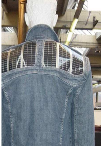
Imagen 2. Campera de Jean, detalle celdas solares en espalda.
