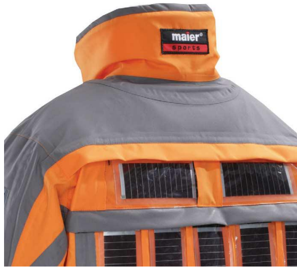
Imagen 1. Primer prototipo, detalle de celdas solares en la espalda.
