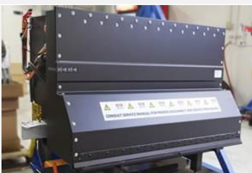
Pack de Baterías en el Tesla Roadster (Li-Ion)
