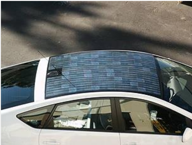
Panel Solar en el techo de un Toyota Prius
