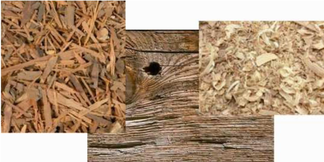
La madera es un material ortotrópico encontrado como principal contenido del tronco de los árboles. Estos están compuestos por fibras de celulosa unidas con lignina. Una vez cortada y secada, la madera se utiliza para muchas aplicaciones.
