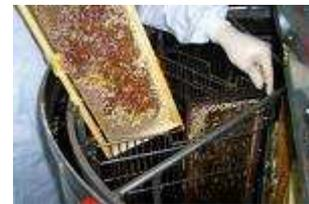
Por último, la miel extraída pasa por un filtrado, para impedir impurezas. La miel obtenida del filtrado se deposita en tambores de 330Kg, bromatológicamente aptos.
