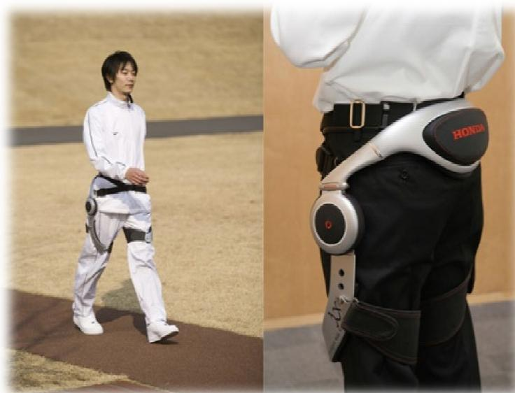
sus automóviles que por este tipo de productos. Parece que usa algunas tecnologías desarrolladas por Honda para el robot ASIMO. Este asistente obtendría información de los sensores en la cadera, para ayudar al usuario a mantener una postura erguida, y usa motores para incrementar la fuerza de los pasos. Honda dice que será ideal para la gente mayor, y para quienes tengan piernas con músculos débiles.
