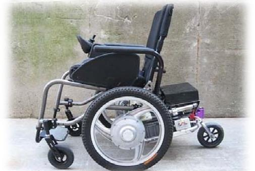
La solución a esta problemática llega de la mano de la silla Kangan Roo. La idea es sencilla y se basa en utilizar el chasis de una silla activa, acoplando un sistema eléctrico adicional en la parte trasera.
