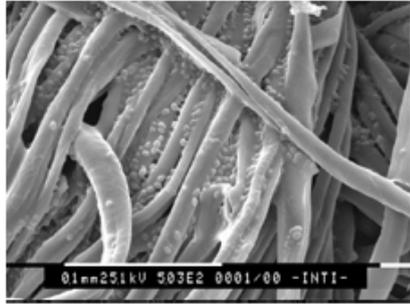
Fig. 11: Microfotografía M.E.B. de un tejido impregnado con microcápsulas de levadura con aceite esencial de limón encapsulado. (500x)
