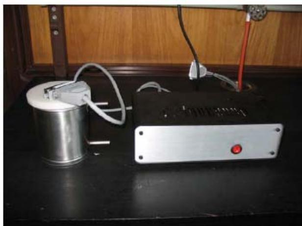
Las muestras se colocan en el interior de una cámara de compartimiento estanco y sus vapores son detectados mediante un conjunto (array) de 12 sensores de gases con diferentes selectividades frente a los vapores de las muestras.
