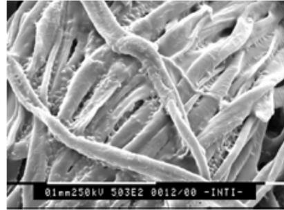
Fig. 12: Microfotografía M.E.B. de un tejido lavado, impregnado con microcápsulas de levadura con aceite esencial de limón encapsulado (500x)
