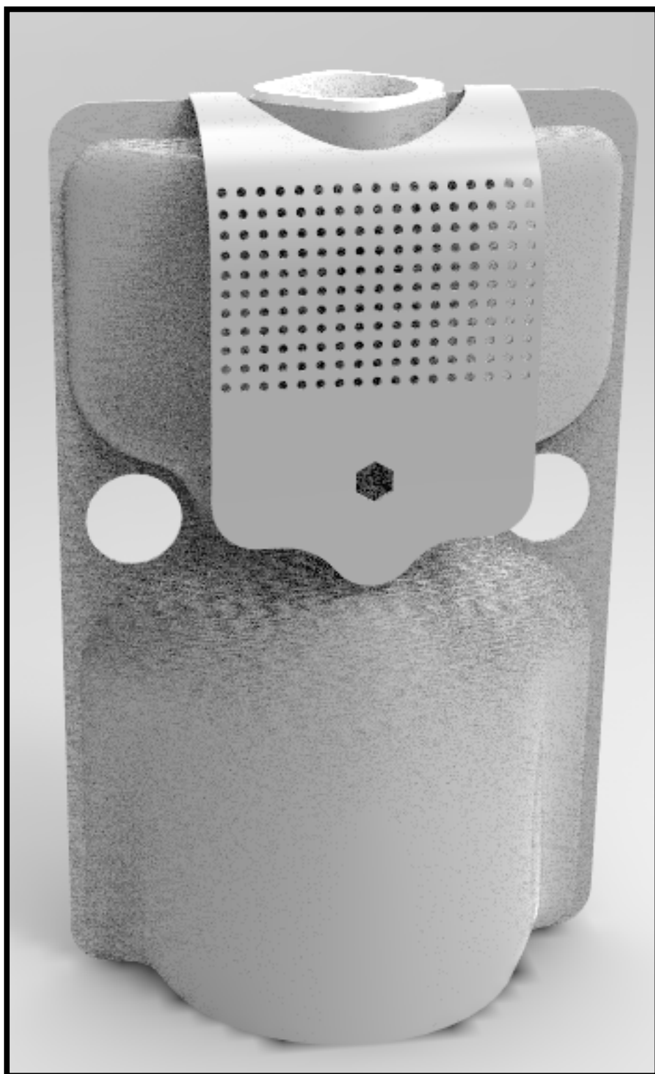
Figura A14: Perspectiva en detalle de los orificios para colocar manos y del pre-filtro.
