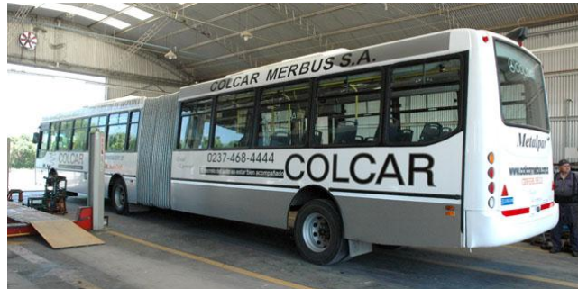
Carrocería Colcar y chasis Mercedes Benz, con capacidad para 140 pasajeros
