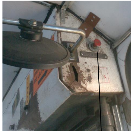
Botón de emergencia para abrir las puertas.
