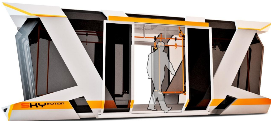
Las dimensiones del acceso cuando las puertas están totalmente abiertas son de 1.350 mm x 2.000 mm.
